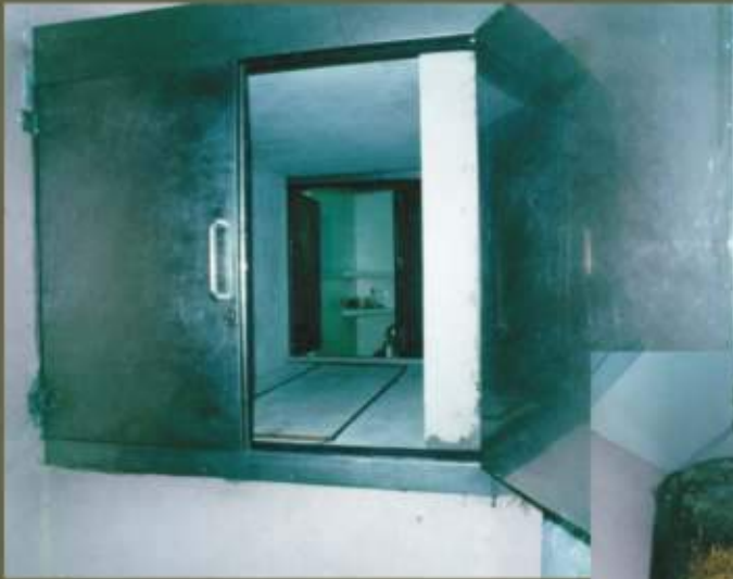
Fig. 18. Túnel de pasteurización con doble puerta de sellado hermético, para pasteurización con vapor.
