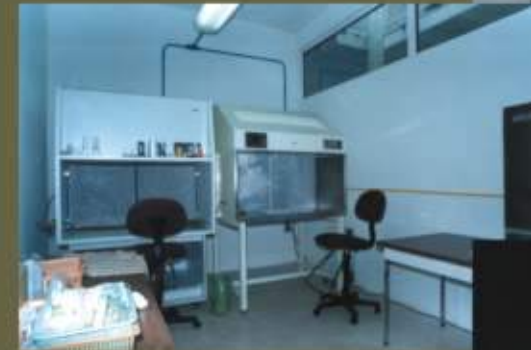
Fig. 6. Área estéril con cámaras de flujo laminar recomendables para trabajar en condiciones de asepsia.
