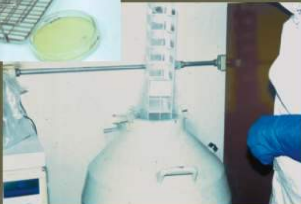
Fig. 12. Contenedor con nitrógeno líquido para conservar las cepas a -196 °C.
